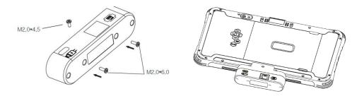
Ya instalado el conector POGO Pin, para poder emplearlo debe de actualizarse en la Tableta BioPad, para ellos vaya a *Ajustes* y seleccione la opción **Docking Station**, en dicha opción deberá de activar las opciones: Host mode y Ethernet para poder utilizar la tarjeta de RED:
