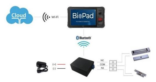
Como primer paso debe conectar el relevador a corriente eléctrica por medio del cargador, el cual tomará 10 segundos en visualizarse en su tableta y pueda ser activado.
