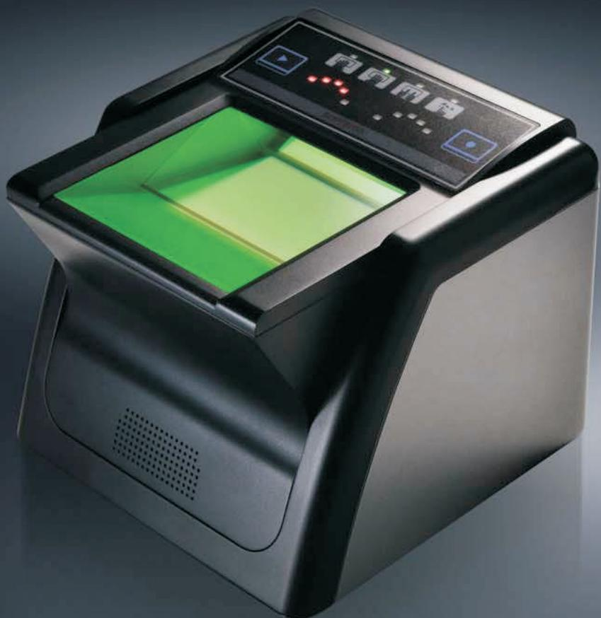
RealScan-10 es un escáner compacto para captura individual o de hasta 10 huellas. La avanzada tecnología óptica de Suprema permite captura de imagen de alta velocidad y procesamiento exacto. Su estructura acorde a la norma IP54 resistente al polvo y al agua la convierten en una solución adecuada para interior e incluso para ambientes móviles. Con su probada certificación FBI, RealScan-10 es el escáner portátil perfecto para aplicaciones civiles y criminales.
